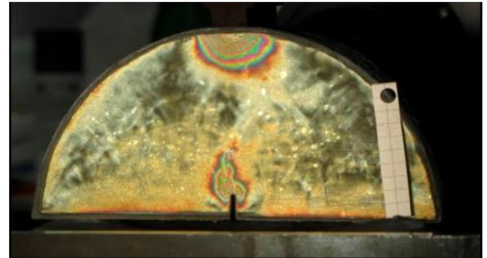
Probekörper aus Asphalt AC 8 D S unter Belastung im Halbzylinder-Biegeversuch
